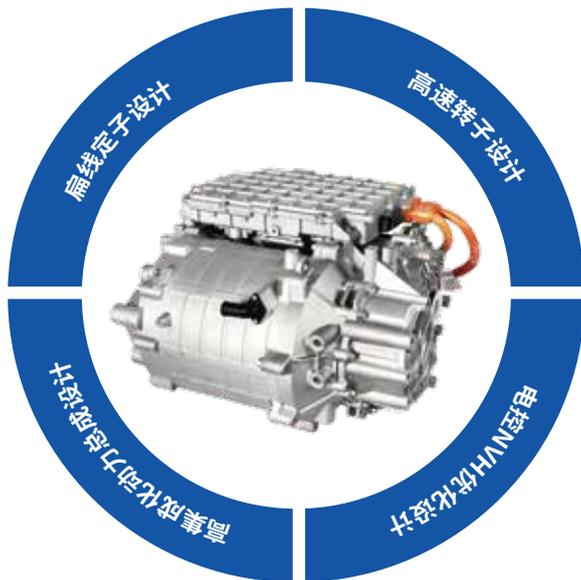
动力总成产品覆盖40 ~200Kw, 输入扭矩覆盖1000 ~5000Nm, 平台化与定制化并融, 全方位覆盖各类车型。
